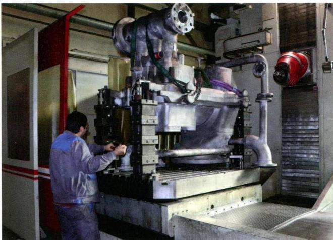
Bild 3: Das Ausrichten eines solchen zweigeteilten Turbinengehäuses auf dem Maschinentisch des Bohrwerks kann je nach Verzug acht bis zwölf Stunden in Anspruch nehmen
