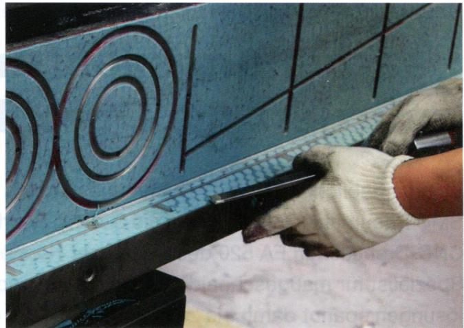
Bild 10: Sämtliche Flachführungen der Hwacheon-Maschinen sind handgeschabt und poliert. So treten selbst bei Hochleistungszerspanungen kaum Vibrationen auf. Die dadurch erhöhte Stabilität sorgt für höhere Präzision und Verfügbarkeit sowie längere Stehzeiten (Werkbilder: HWACHEON Machinery Europe GmbH, Bochum)
