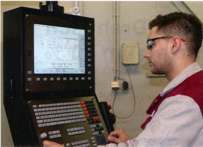
Bild 9: Alle Maschinen im Bereich Zerspanungstechnik sind mit Heidenhain-Steuerungen ausgestattet. Auch die Hwacheon Vesta-1050B erhielt auf Anwenderwunsch diesen Steuerungstyp, damit jeder Bediener problemlos an allen Maschinen arbeiten kann
