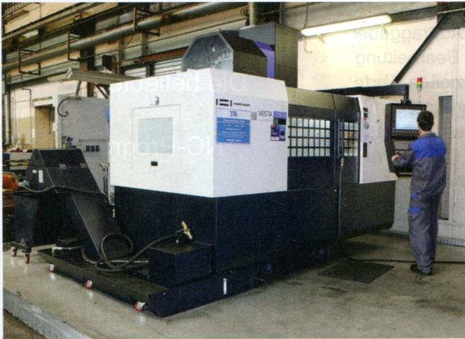
Bild 5: Die Hwacheon Vesta-1050B wurde vom Hersteller speziell für die Schwerzerspannung ausgelegt und bietet zähe, hochfeste Flachführungen in allen Achsen für hohe Präzision und beste Arbeitsergebnisse
