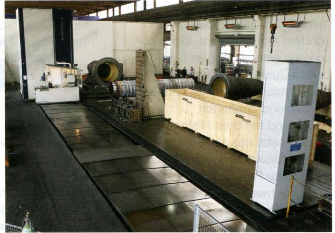
Bild 2: Das 2010 in Betrieb genommene Großbohrwerk ist in einem eigenen Hallentrakt untergebracht. Darauf können Großteile mit Längen von bis zu 24 m und Höhen von bis zu 6 m sowie Gewichten von bis zu 100 t bearbeitet werden
